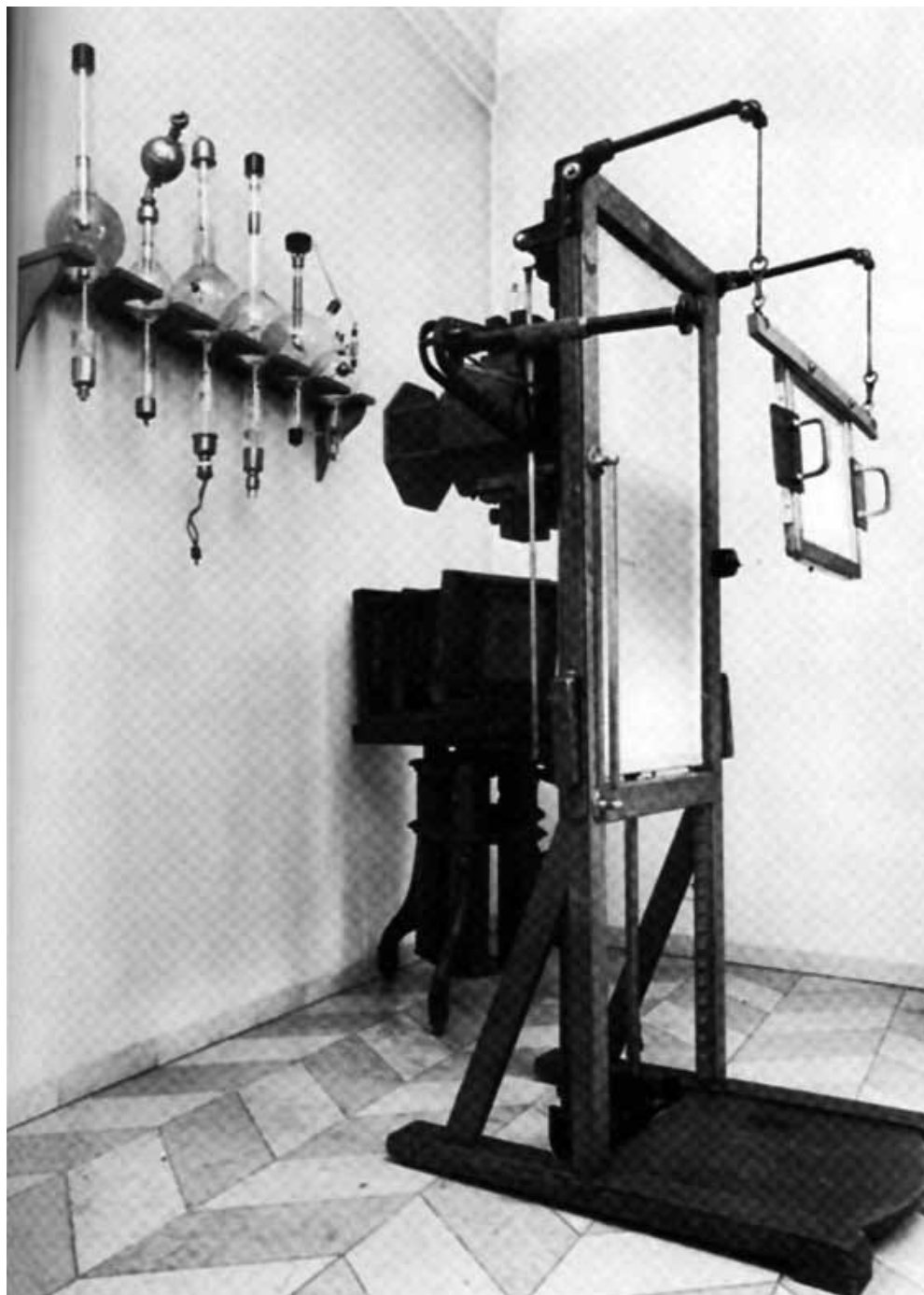
[Foto 16] Aparato de rayos x para fluoroscopia de tórax. Tubos de reemplazo.
